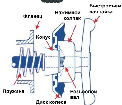
Центрирование с помощью заднего конуса
